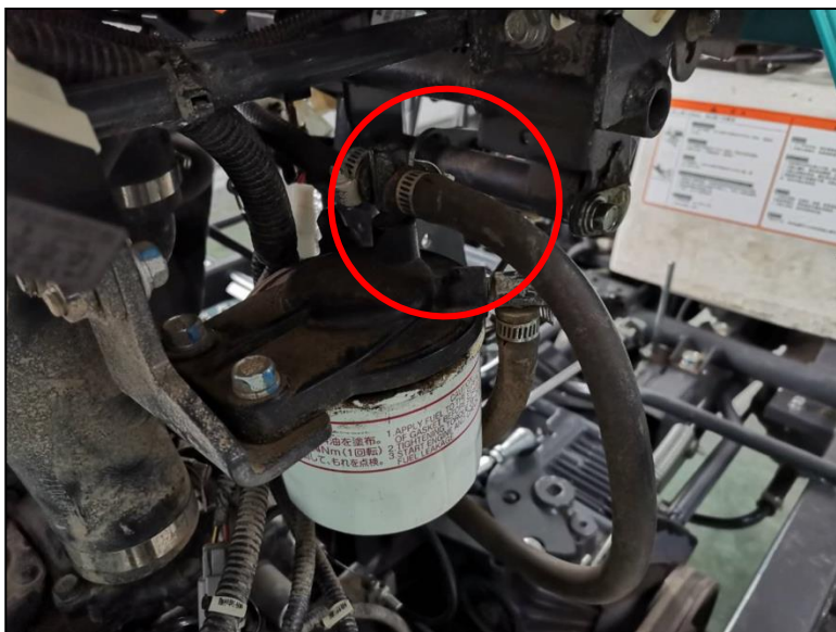
油管松动、破损
