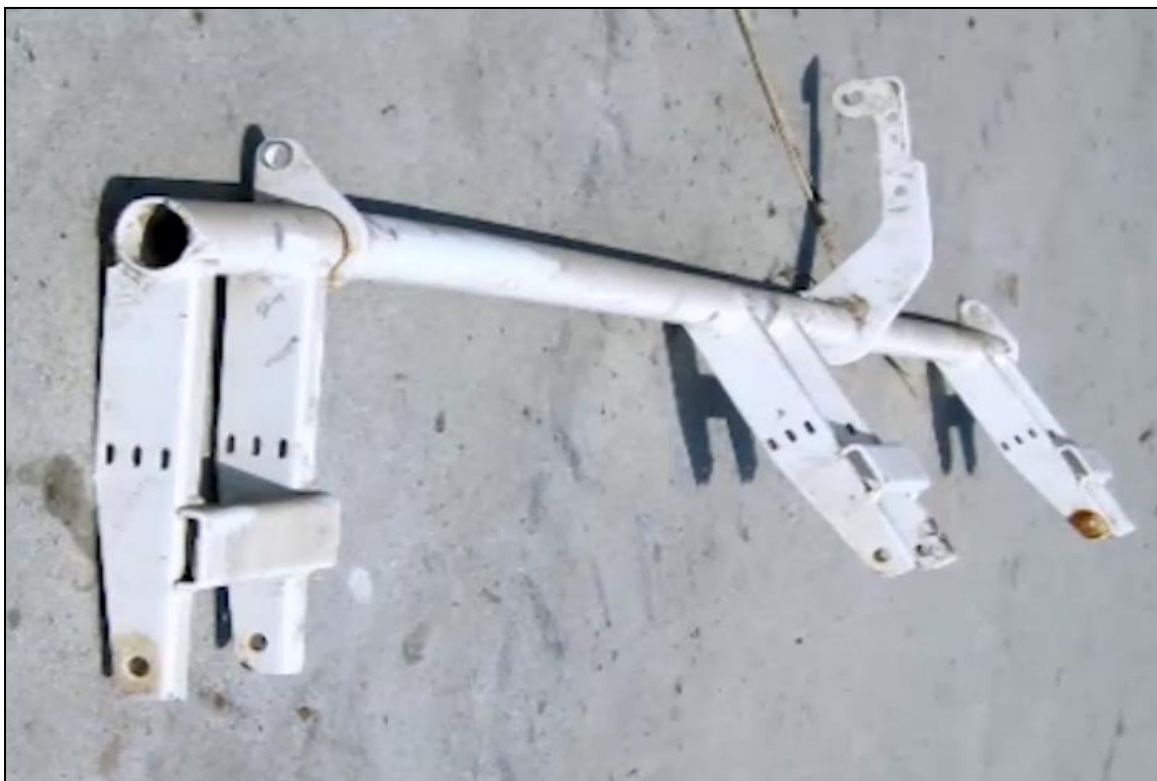
浮舟支架变形
