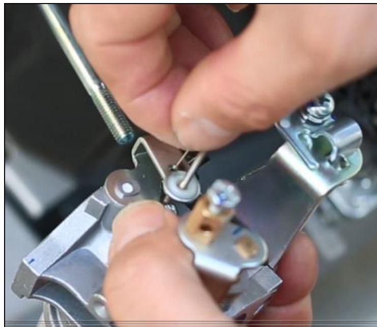
卸下油门张紧弹簧和油门支架 这是正确的拆卸方法
