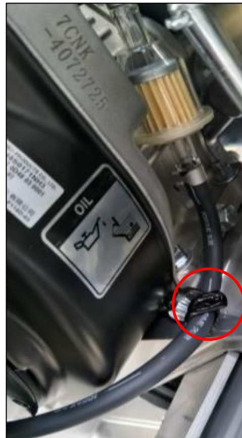
燃油管变形，油流不下去
