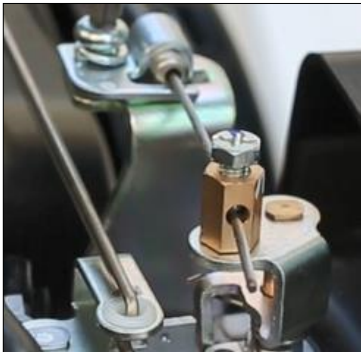
卸下封门螺栓抽出封门线
