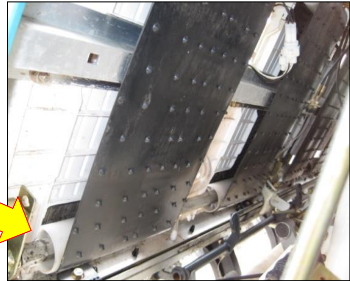
皮带磨损，变形
