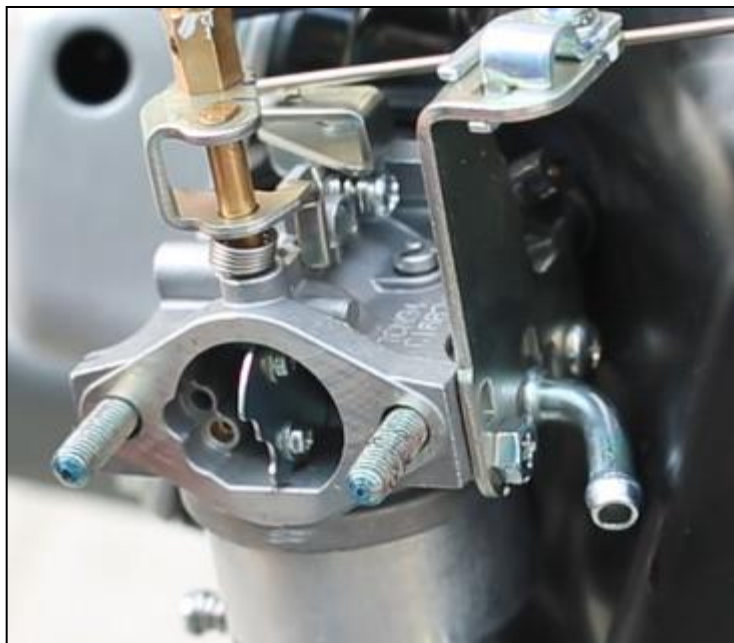
卸下固定螺栓与油管
