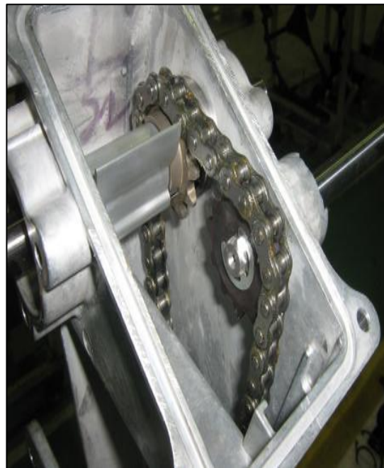
链条断裂、变形拉长 栽秧台不动或移动量小
