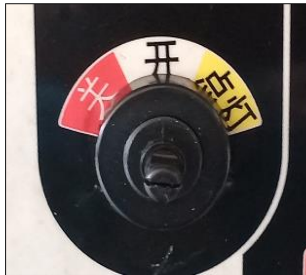
损坏的主开关
